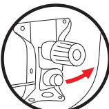
Поверните рукоятку по часовой стрелке, чтобы затянуть пружину.
